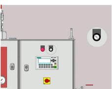
Wechsel zu gesicherten Betriebs- und Programmier-ebenen durch **Schlüsselschalter**.
