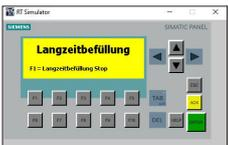
Meldungen bei eingeschaltetem **Sonderbetrieb** wie der Langzeitbefüllung, bei welcher Laufzeitbegrenzungen temporär aufgehoben werden. Die Rückkehr in den Normalbetrieb erfolgt automatisch.
